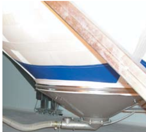
■ Dno wibrujące w silosie z płótna Trevira
