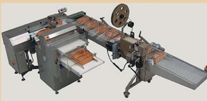
■ Linia automatyczna: krojenie i pakowanie w torebkę.
