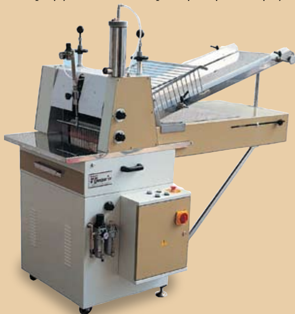
■ Krajalnica 450/400 automatyczna o nożach trakowych z pneumatycznym przesuwem popychacza, przeznaczona do krojenia różnego typu pieczywa. Wydajność 400-600 szt./h.
