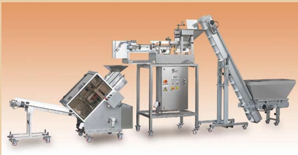
■ Pakowaczka pionowa mod. VTR1 z automatycznym systemem załadunku. Wydajność ok. 10-15 opakowań/min.
