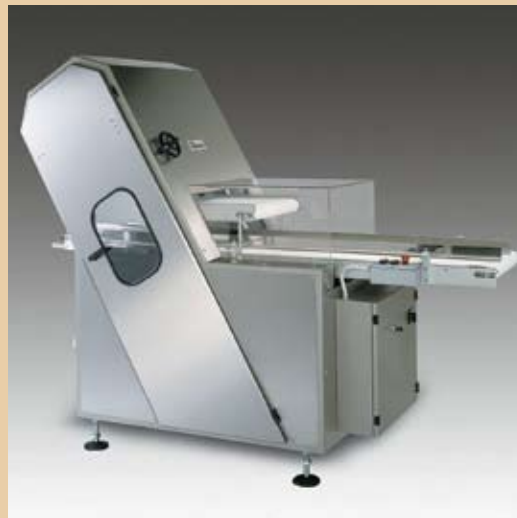
■ Kraljnicia mod. 1700, o nożach taśmowych automatyczna o wydajności do 1800 szt./h. Przeznaczona do krojenia każdego typu pieczywa.
